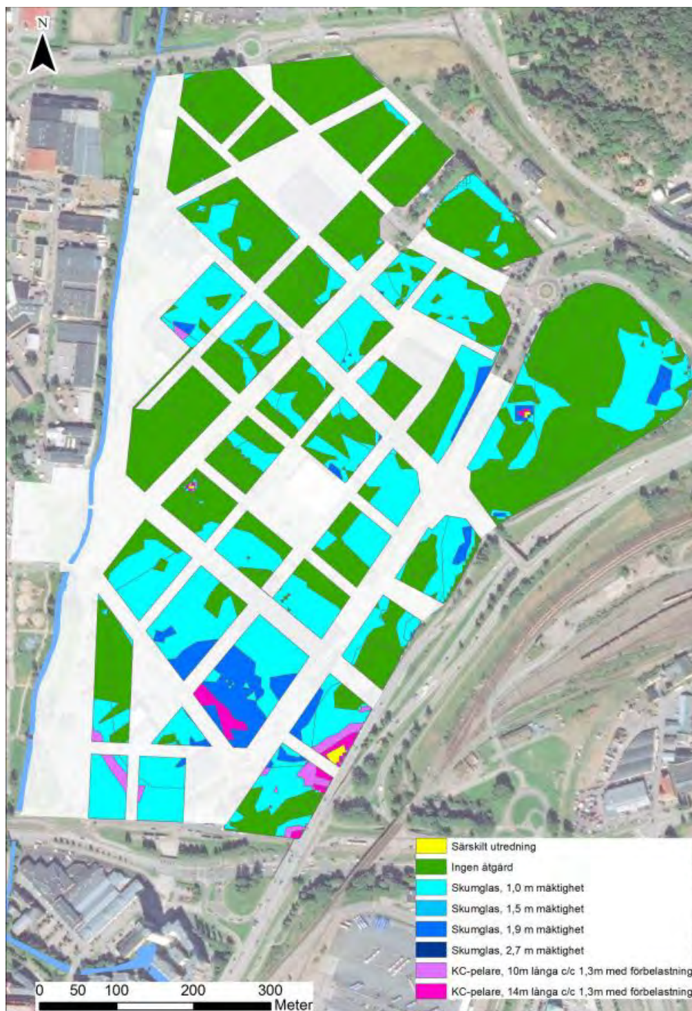
Figur 7: Exempel på geotekniska åtgärder på kvartersmark, grönyta
